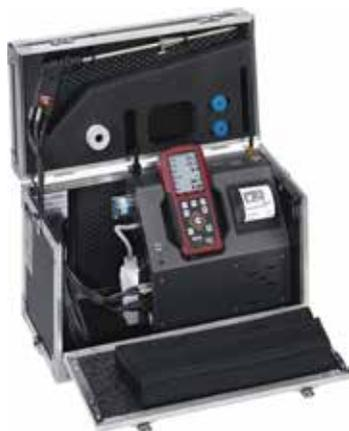
L'analizzatore MRU NOVAplus rappresenta una soluzione all'avanguardia per tutte le esigenze di controllo della combustione su impianti industriali, alimentati sia da combustibili tradizionali che da fonti rinnovabili quali biomasse, biogas e syngas.
