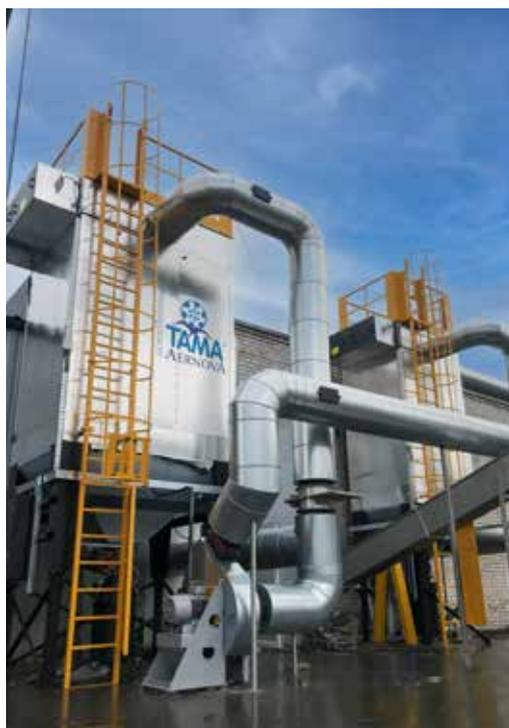
Funzionali alla filtrazione descritta sono i sistemi  $DeSO_x$  e  $DeNO_x$ , studiati ed ingegnerizzati da TAMA AERNOVA, che attraverso l'additivazione di sostanze come calce idrata, bicarbonato di sodio, carboni attivi e urea/ammoniaca, permettono la neutralizzazione dei gas acidi e l'abbattimento dei metalli pesanti generati durante i processi di combustione.
